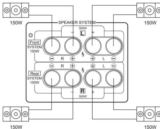
注：当使用 4 声道时，通过调整各自音量的大小，使各系统的 L 和 R 声道的音量输出改变。
