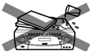
Cấm để bất cứ vật thể nào rơi vào thiết bị này, bởi vì những vật thể này có thể đụng đến điểm điện áp nguy hiểm hoặc làm cho mạch điện ngắn mạch mà dẫn đến hỏa hoạn hoặc giật điện. Cấm để bất cứ chất lỏng nào rơi vào thiết bị này, nếu có vật thể hoặc chất lỏng rơi vào, xin nhổ ra phích điện từ ổ cắm nguồn điện AC và tư vấn nhà tiêu thụ địa phương.
