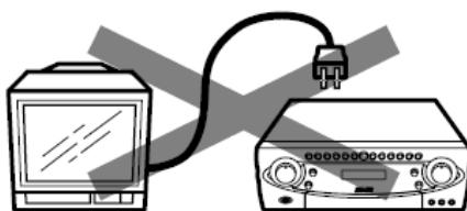
본 장치에는 AC 전원 콘센트가 설치되어 있으며 시스템 소스 구성 요소와 연결할 수 있습니다. 단, 장치의 교류 전원 콘센트가 과부하되지 않도록 주의하십시오. 소비 전력이 뒷면 패널 값을 초과할 경우, 화재 또는 기타 재해의 원인이 될 수 있습니다. 전원 콘센트는 TV를 연결하는 데 사용해서는 안됩니다. TV는 순간에 소정 최대값을 초과할 수 있습니다.
